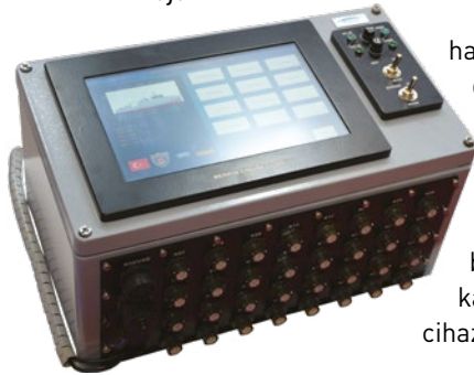
NDDS-300 Gerçek Zamanlı Veri Dağıtım Sistemi
