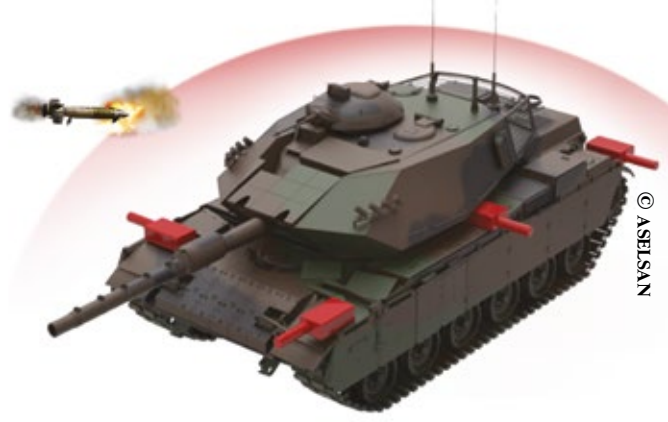
M60 tankına, PULAT aktif koruma sisteminin karşı tedbir modüllerinden 6 tanesi entegre ediliyor.
